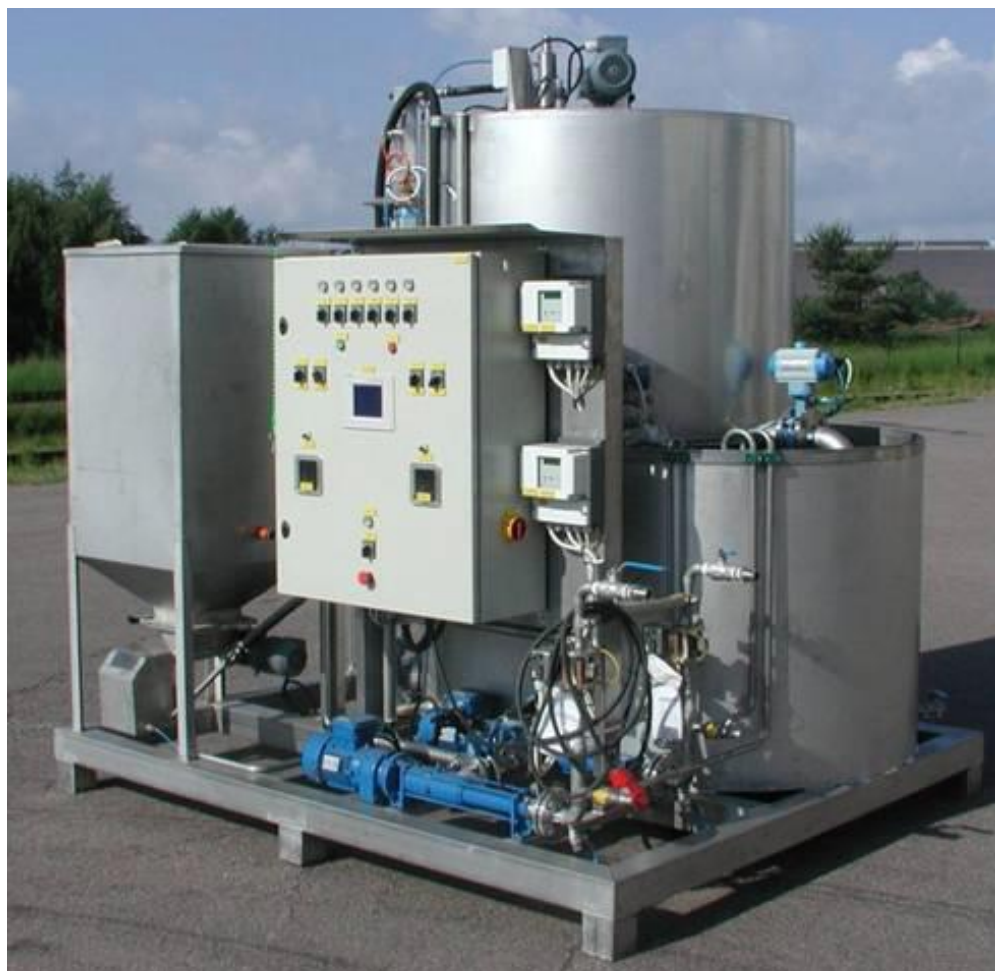
Fot. 1. Stacja do przygotowywania roztworu z polimerów proszkowych
